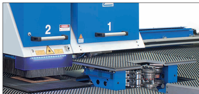
CombiLaser Multipunch mit automatischem Werkzeugwechsler
