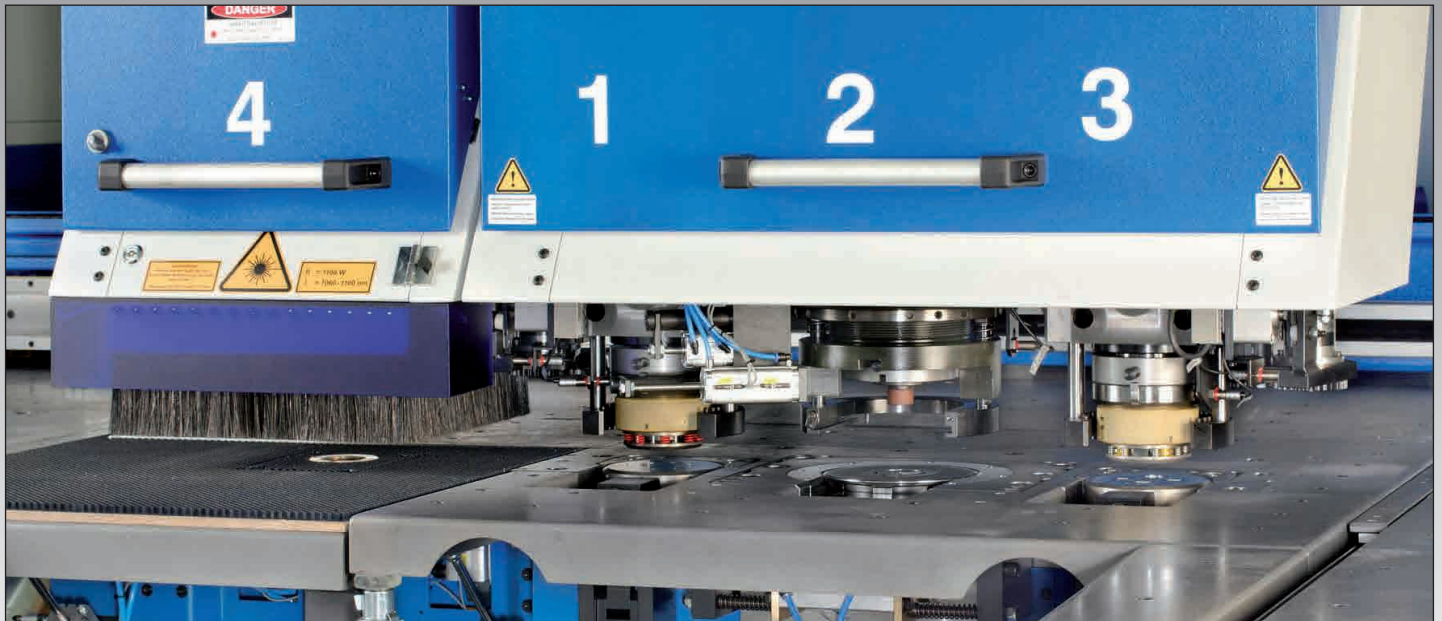
CombiLaser TRI 3 Kopf-Stanzmaschine mit 2xRevotool (Kopf 1 + 3) und Rotation/Index (Kopf 2)
